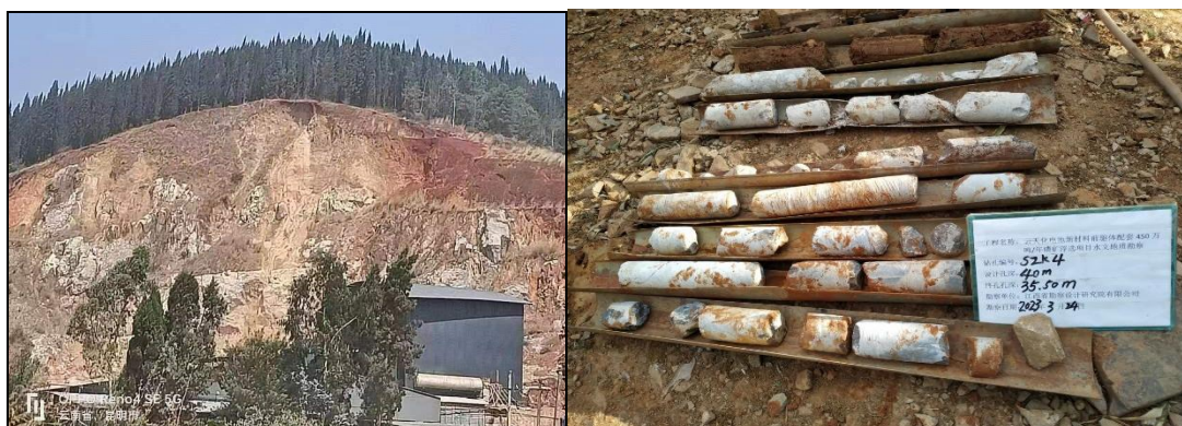
图5.2.5-7 灰岩露头及岩岩芯（中风化）
